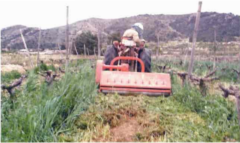
Fig. 3.- Desbrozadora segando y triturando el abono verde y restos de poda (sarmientos). (Foto R. García).
